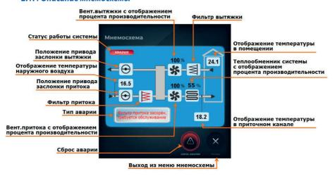
Режим просмотра мнемосхемы представляет собой экран с отображением работы системы в режиме реального времени. Ниже пример мнемосхемы приточно-вытяжной системы с электрическим нагревателем.
