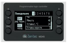
В подменю действия «1» указываем, что параметр «**Точка**» используется, выбираем, в каком состоянии должна быть установка (включиться или выключиться), указываем время, температуру уставки и требуемую скорость.
